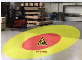
A Weil en Allemagne, **Conductix-Wampfler** a identifié les 5 zones les plus dangereuses dans son magasin et les a équipées de transpondeurs : tous les chariots élévateurs à fourche et les 5 zones les plus dangereuses ont été équipés de transpondeurs qui communiquent avec les chariots élévateurs pour réduire automatiquement leur vitesse, avertir les piétons avec un feu clignotant ou projeter un panneau d'avertissement au sol.
