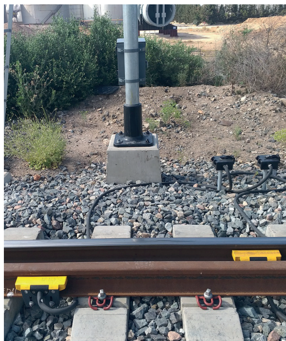
Czujnik koła Frauscher RSR123
