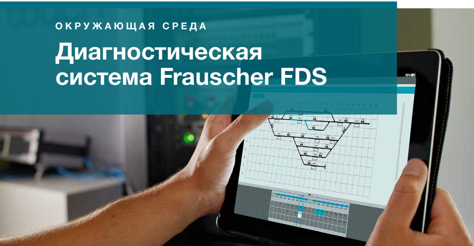
Диагностическая система Frauscher FDS выполняет визуализацию участков пути, контролируемых FAdC, и способствует проведению технического и сервисного обслуживания установленных компонентов. Она обеспечивает высокий уровень прозрачности, гарантируя быстрый доступ к важной дополнительной информации и сохраняя все собранные данные для эффективного отслеживания аварийных ситуаций.
