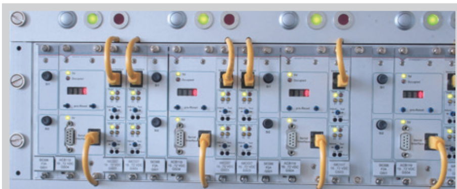
Bild 8: FDS verbunden mit dem Achszählsystem ACS2000
