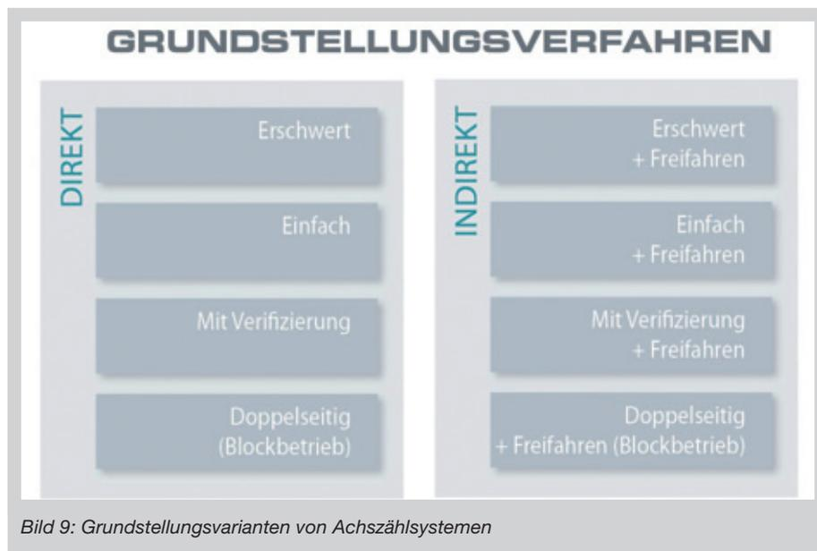
Bild 9: Grundstellungsvarianten von Achszählsystemen
