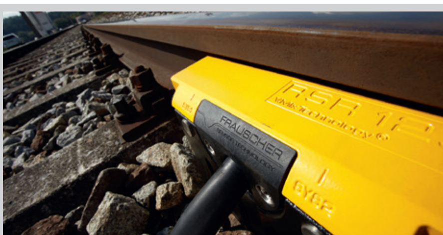
Bild 2: Trend zu Raddetektion und Achszählung zur Steuerung von BÜSA
