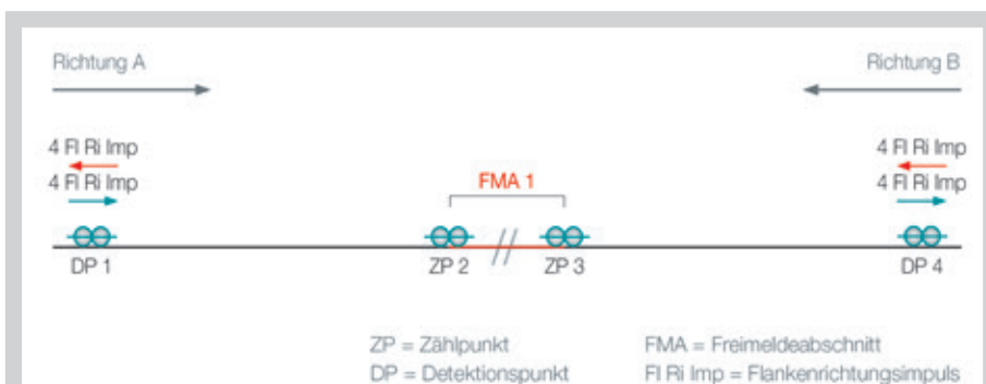
Bild 6: Varianten mit Detektionspunkten und Freimeldeabschnitten
