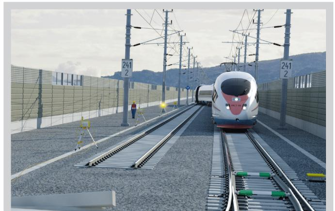
Bild 4: Rottenwarnanlagen werden von Raddetektionssystemen angesteuert
